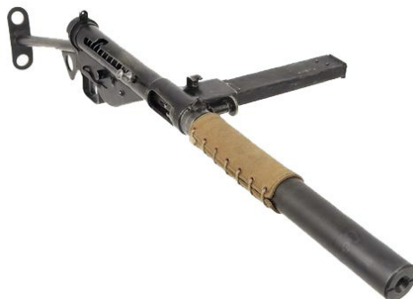
Brytyjski pistolet maszynowy Sten Mk II, kal. 9 mm w wersji S z tłumikiem. Zdjęcie domena publiczna
