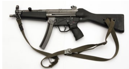
Pistolet maszynowy niemieckiej firmy Heckler & Koch (H&K lub HK) typu MP5, kal. 9 mm, używany przez operatorów Jednostki Wojskowej „GROM” przede wszystkim podczas taktyki „czarnej” i „niebieskiej”. Arsenał Jednostki Wojskowej „GROM”
