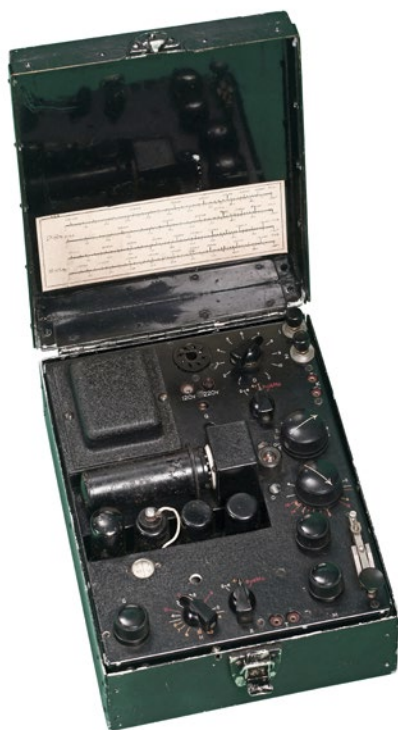
Jedna zrzutowych i przenośnych radiostacji typu AP (w sumie było ich pięć typów: AP-1, AP-2, AP-3, AP-4 i AP-5) konstrukcji inż. Tadeusza Heftmana produkowanych przez Polskie Wojskowe Warsztaty Radiowe w miejscowości Stanmore pod Londynem. Zbiory Muzeum Wojska Polskiego w Warszawie
