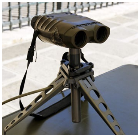
Amerykańska lornetka z wektorowym dalmierzem laserowym służąca snajperowi do obliczania prawidłowych danych balistycznych (w tym między innymi odległości do celu), aby skutecznie wyeliminować z dalszych odległości przeciwnika. Zdjęcie domena publiczna
